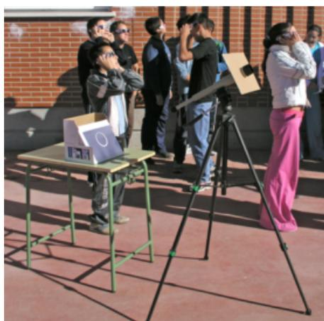
**La projection avec un télescope ou une lunette** Le sténopé n'agrandit pas l'image. Il n'est donc pas possible d'observer, par exemple, les transits de Mercure par cette méthode. Il est possible d'utiliser un télescope auquel on a enlevé l'oculaire pour projeter l'image du Soleil sur une feuille ou un écran.
